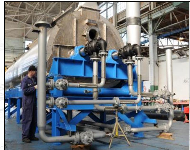
Шарнирные соединения подачи терможидкости с гибкими трубными соединениями (компенсаторами).
