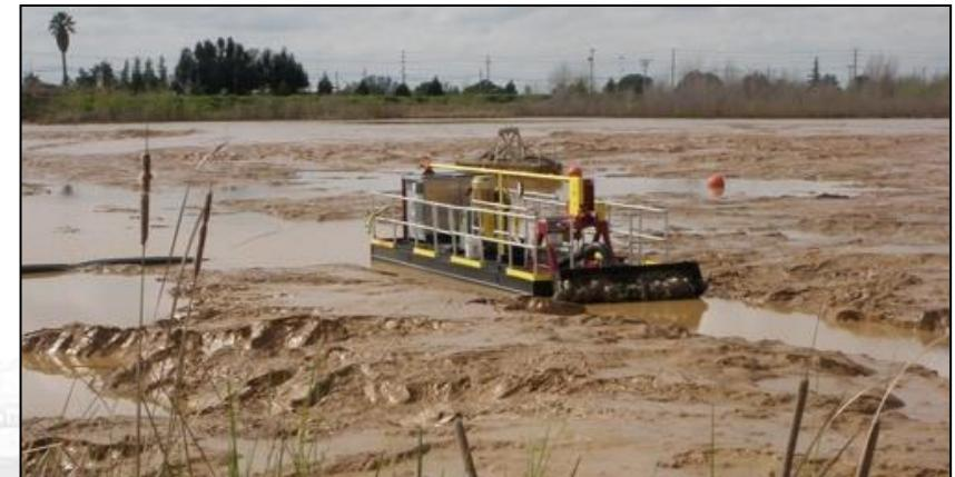
Удаление плотных осадков с помощью драги "Mud Cat 815".
