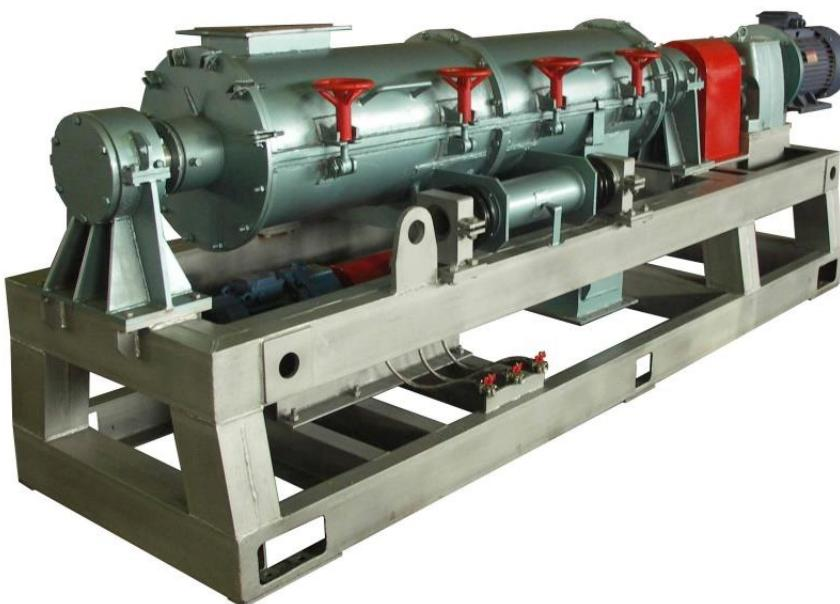
Внешний вид гранулятора, установленного на раме.
