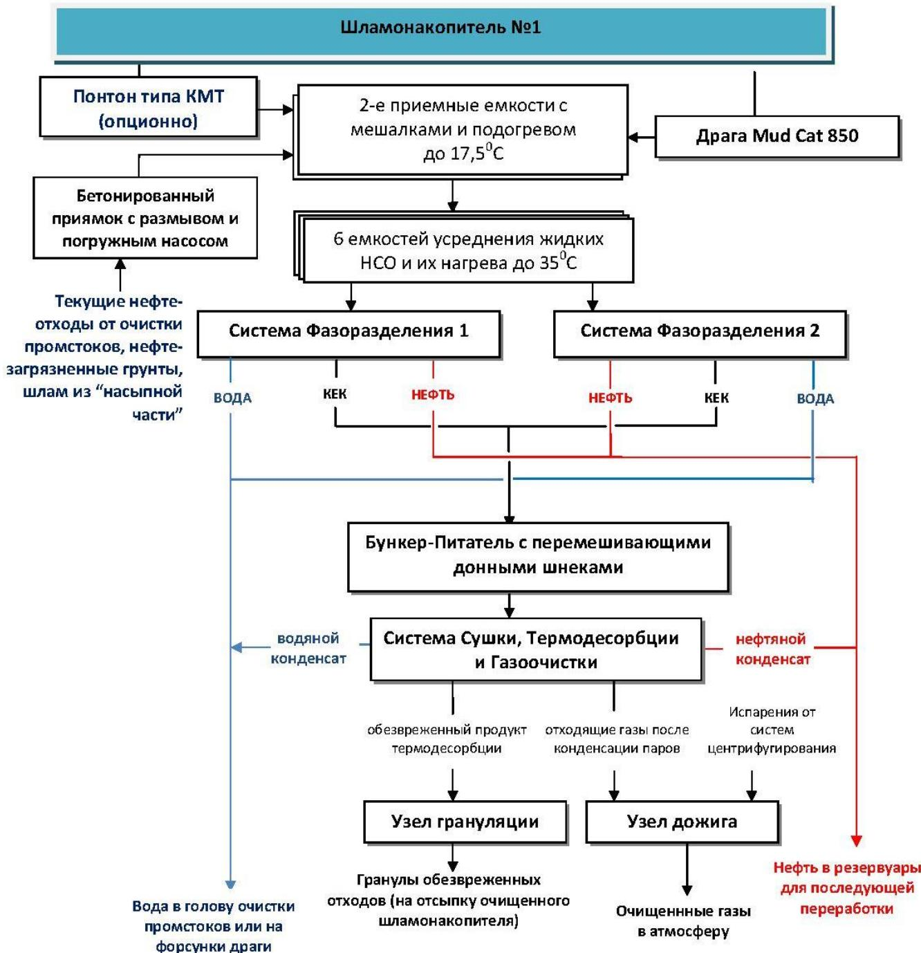
Извлечение донных шламов из шламонакопителя осуществляется с помощью специальной драги "Mud Cat 815" производства компании LWT LLC Dredging Systems, которая позволяет извлекать, как твердые донные отложения, так и жидкие нефтешламы из верхних слоев пруда.
